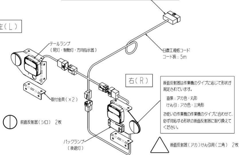
後面反射器は作業機のタイプに応じて形状が
