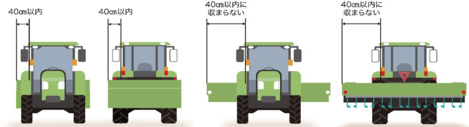
■道路運送車両法の保安基準により、各種灯火器類の取付け位置は以下のように定められています。
